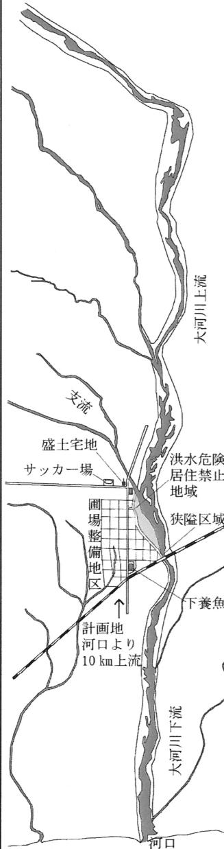
し、そこに1.5m高の盛土をして住宅用地を造成する計画である この移転先誘導地区は洪水被害危険度は比較的に低いが大河川から近く50年に1度堤防溢水が発生する場合があると想定して盛土宅地を整備、さらに洪水遊水池を兼ねてサッカーグラント(GL-3m)と附属する湧水貯留槽(地下)を設け、洪水被害を防止する さらに養魚池(上かみ、下しも、2か所、通常時水面高GL-1.5m)を建設、下流にある鉄道線路の浸水を防止する遊水池目的と農地水利調整を兼ねる 洪水危険度が高い地域を、洪水時水没許容土地利用(=農地)に転換、この農地耕作権を取得し
