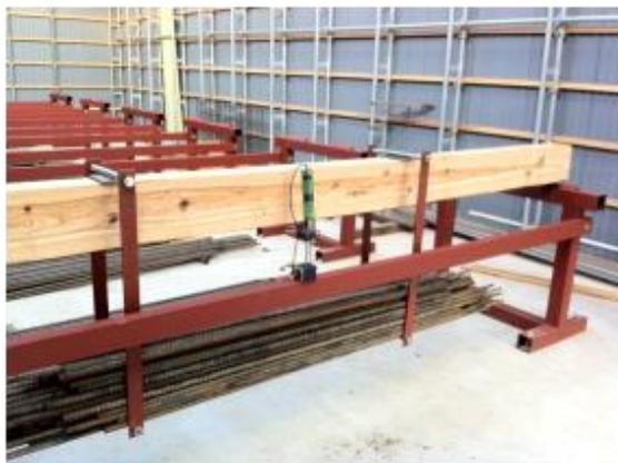
写真2 杉材・実大梁のクリープ試験(4)
