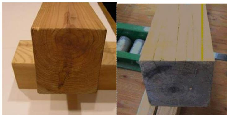
写真3 低温乾燥材と高温乾燥材<sup>(18)</sup>
